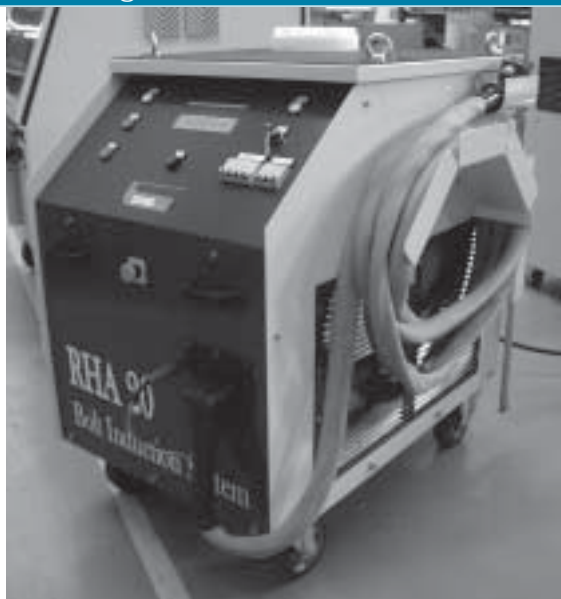
La macchina di ultima generazione RHA 20 per il montaggio e lo smontaggio di turbine.
