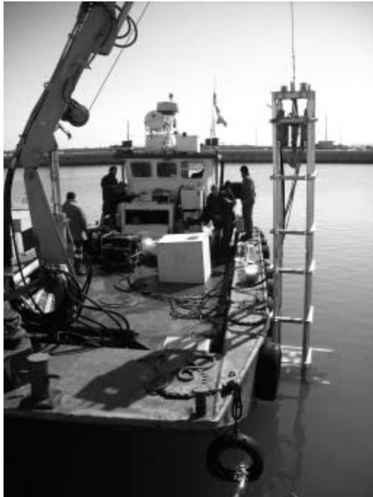
A destra dall'alto: motonave carotatrice. Operazioni per l'acquisizione di campioni da fondale nel Porto di Livorno: lavaggio attrezzature di carotaggio e verifica dati su monitor.
