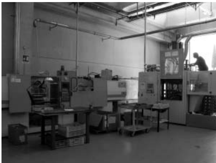
Foto in alto: macchinario per l'iniezione della gomma. A sinistra: torni di varie forme e dimensioni per la realizzazione di rondelle.
