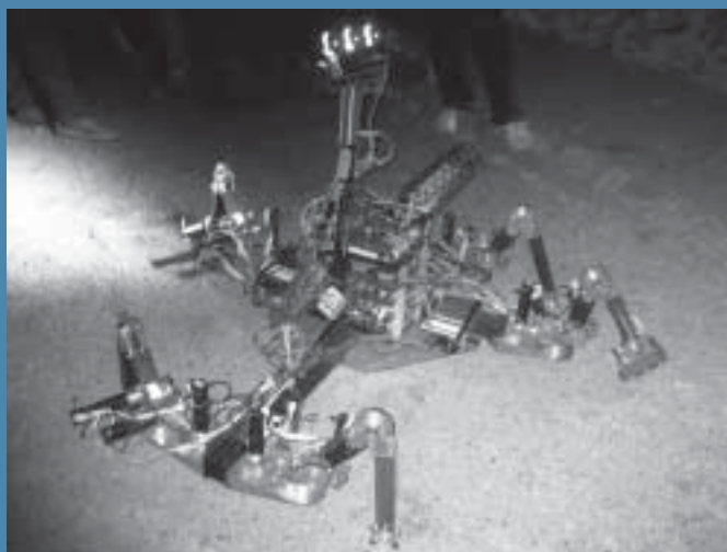
Il robot Pesapod, messo a punto dall’ARTS Lab del Polo Tecnologico Sant’Anna Valdera, per la perlustrazione del territorio lunare; il progetto avrà future applicazioni “terrestri” nel campo della meccanica e dell’elettronica.
